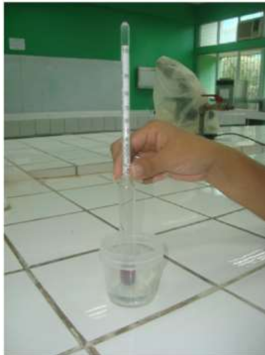
Figura 26. Medición de la concentración de alcohol mediante el uso de un alcoholímetro.
