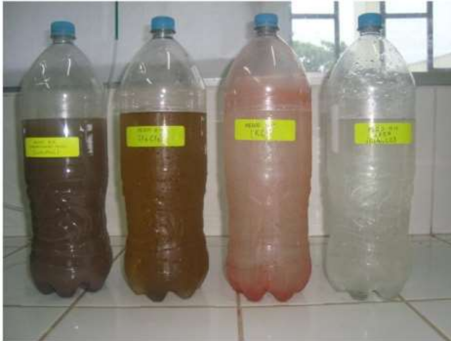
Figura 19. Se aprecia el Tratamiento 3 (medio H.M.). Consta de cuatro patrones: superfosfato simple de calcio, cloruro férrico ( \text{FeCl}_3 ), cloruro de potasio (KCl) y úrea.
