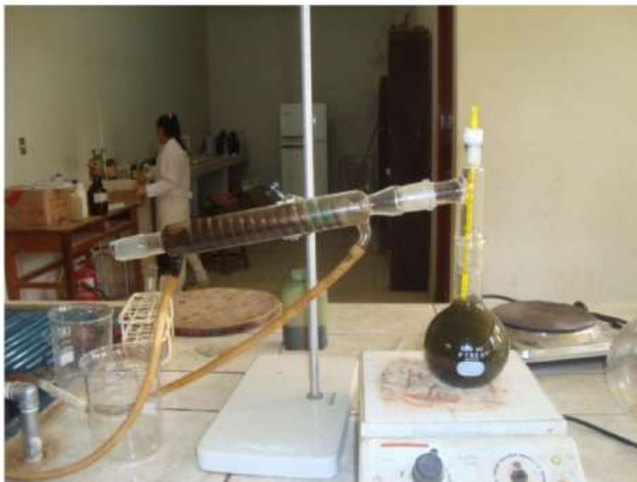
Figura 24. Destilación del bioetanol de microalgas ( Chlorella sp. ).
