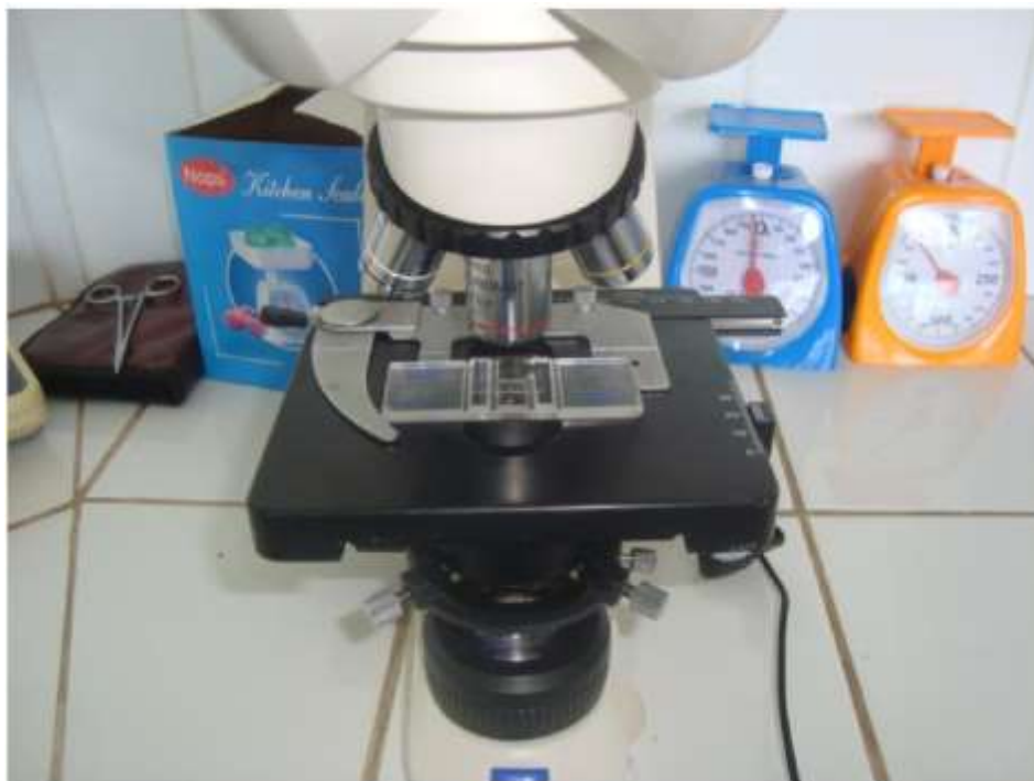
Figura 12. Conteo de la densidad celular con la ayuda un microscopio y del hematocímetro (cámara de Neubauer).
