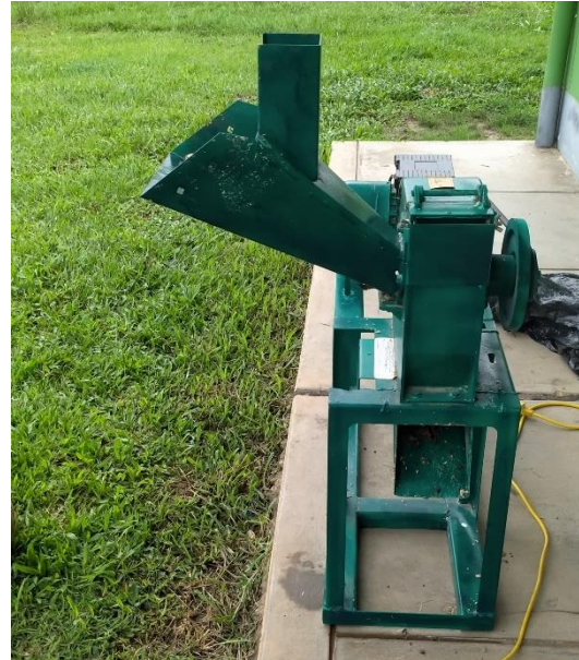
Máquina de Trituración de residuos orgánicos
