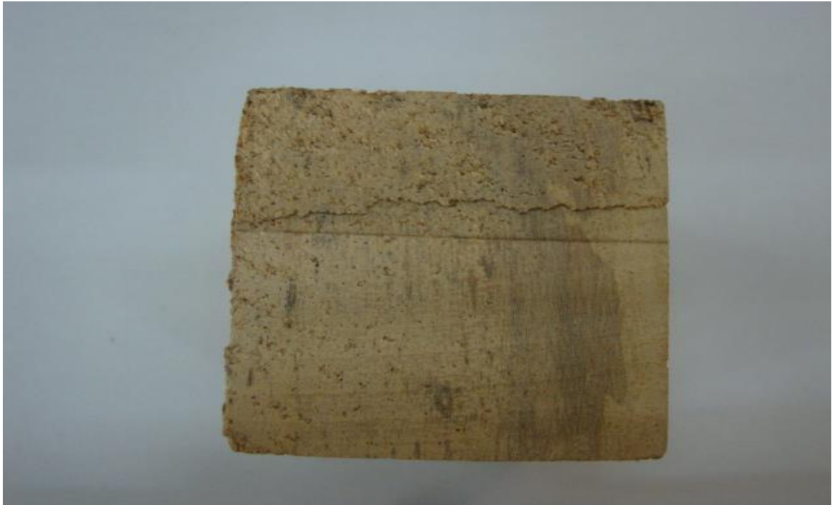
Figura 13A. Tipos de fallas en el ensayo de cizallamiento paralelo al grano.
