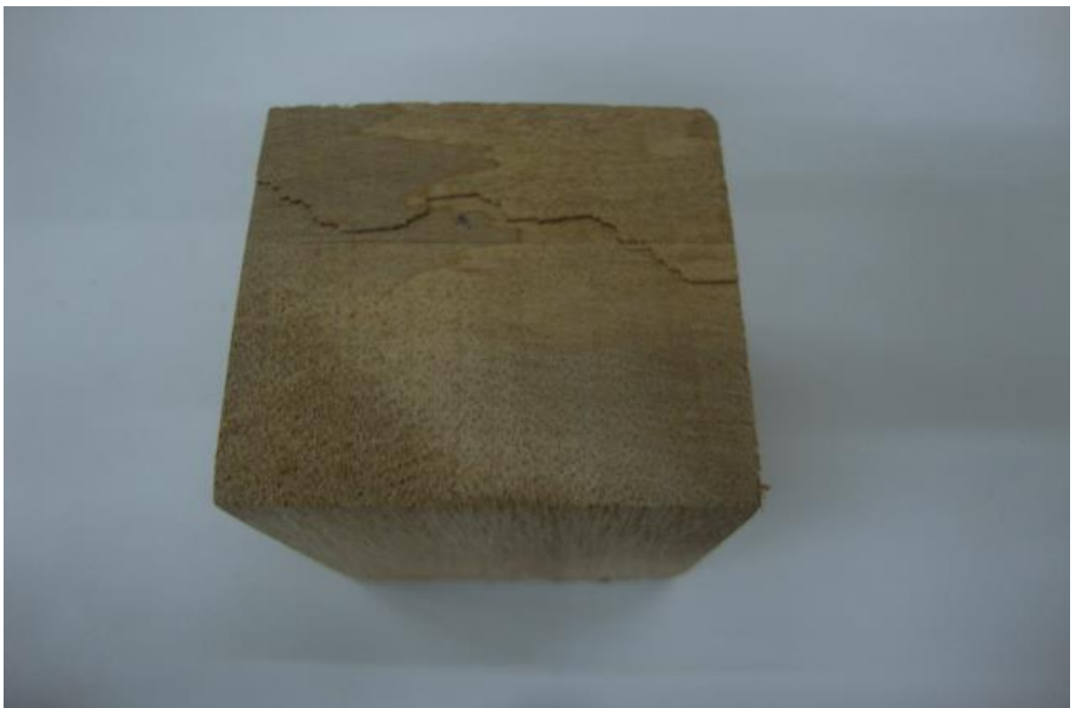
Figura 14A. Tipos de fallas en el ensayo de cizallamiento paralelo al grano.
