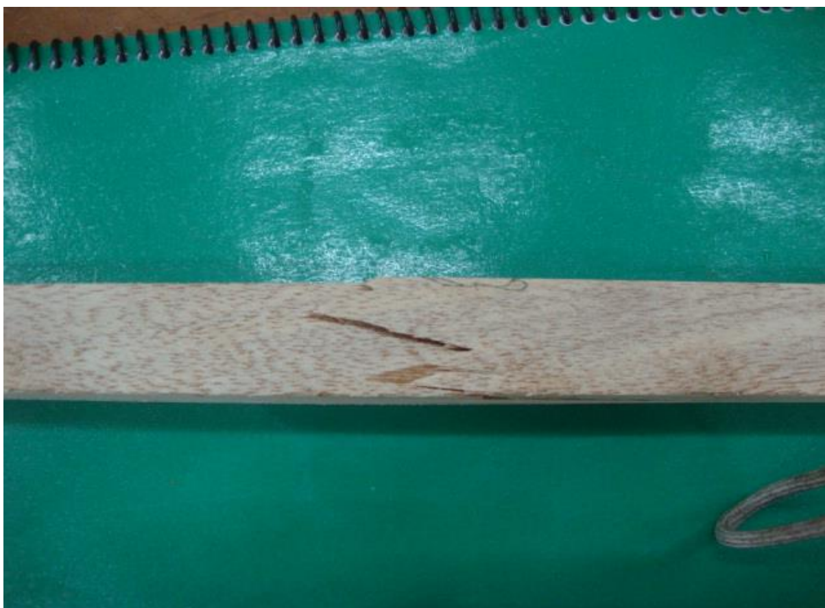
Figura 4A. Tipos de fallas en el ensayo de flexión estática.
