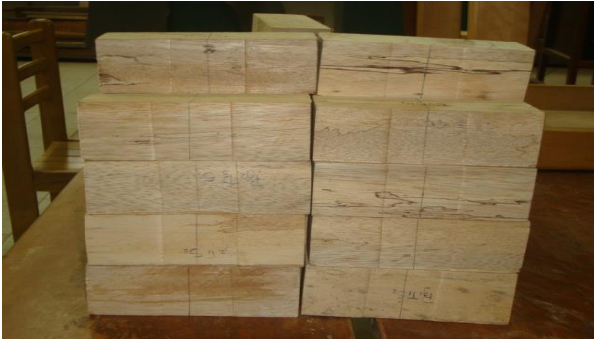
Figura 1A. Probetas para los ensayos mecánicos de la madera de marupa.
