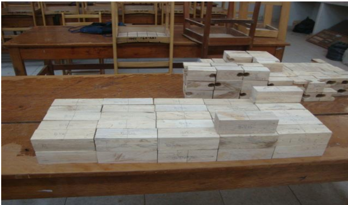
Figura 2A. Probetas para los ensayos mecánicos de la madera de marupa.
