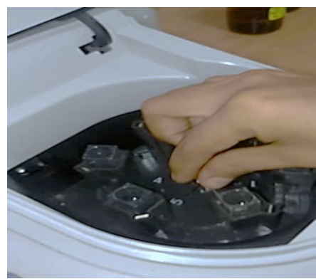
Colocación de la cubeta en el Espectrofotómetro UV/Vis.
