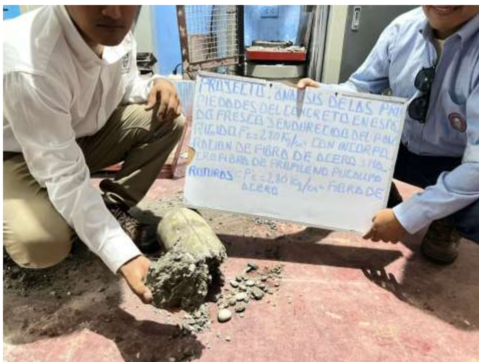
Vista de presencia de fibra de acero en probeta ensayada
