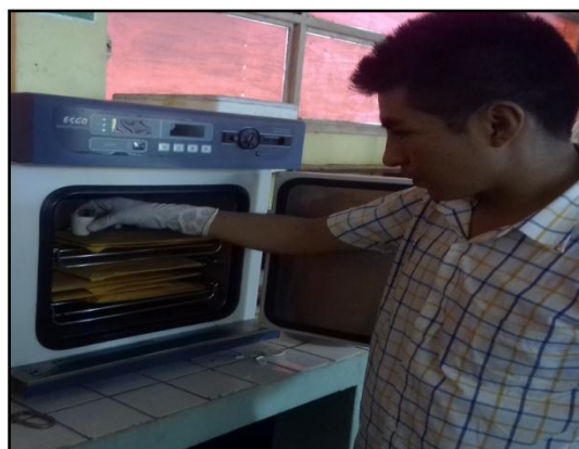
Figura 25. Secado de las hojas en estufa de aire forzado para la obtención del bioadsorbente
