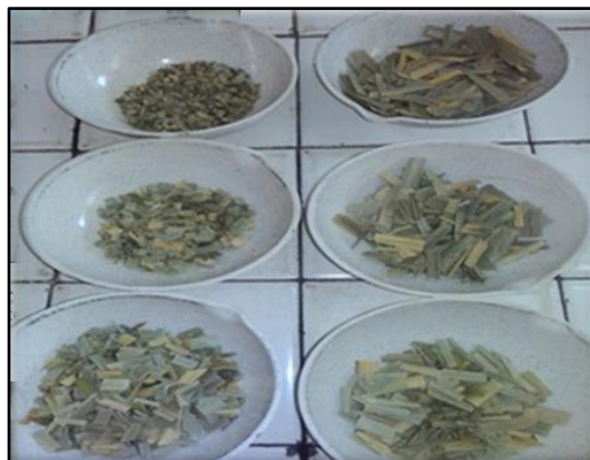
Figura 27. Muestras bioadsorbentes seccionadas en longitudes de 0.25, 0.50, 1.00, 1.50, 2.00 y 2.50 cm
