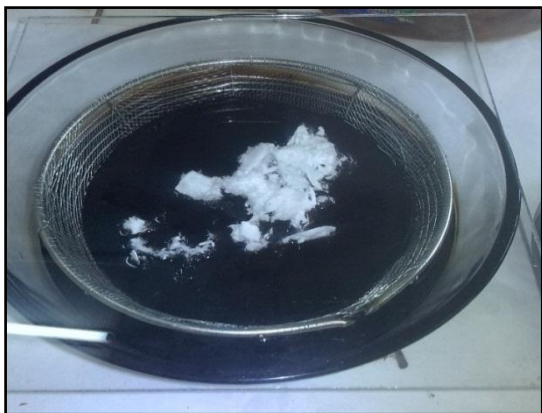
Figura 38. Muestra de adsorbente comercial sintético (TC1) en pleno ensayo.
