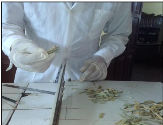
Figura 26. Dimensionado del bioadsorbente según la longitud requerida
