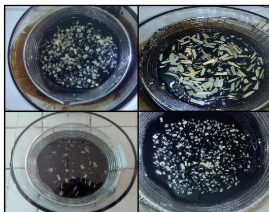
Figura 31. Bioadsorbentes de diferente longitud en pleno ensayo
