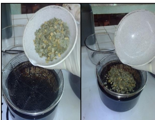
Figura 30. Procedimiento de puesta de la muestra bioadsorbente en la cesta de adsorción
