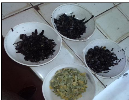
Figura 36. Muestras bioadsorbentes antes y después del ensayo.
