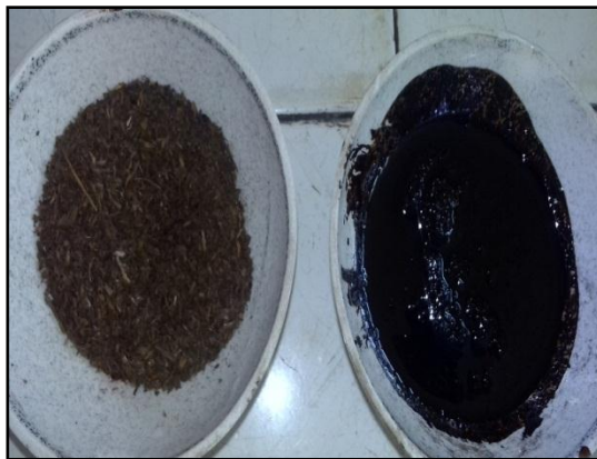
Figura 39. Muestra de adsorbente comercial orgánico (TC2) antes y después del ensayo.
