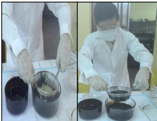
Figura 32. Procedimiento de puesta y retiro de la cesta de adsorción.
