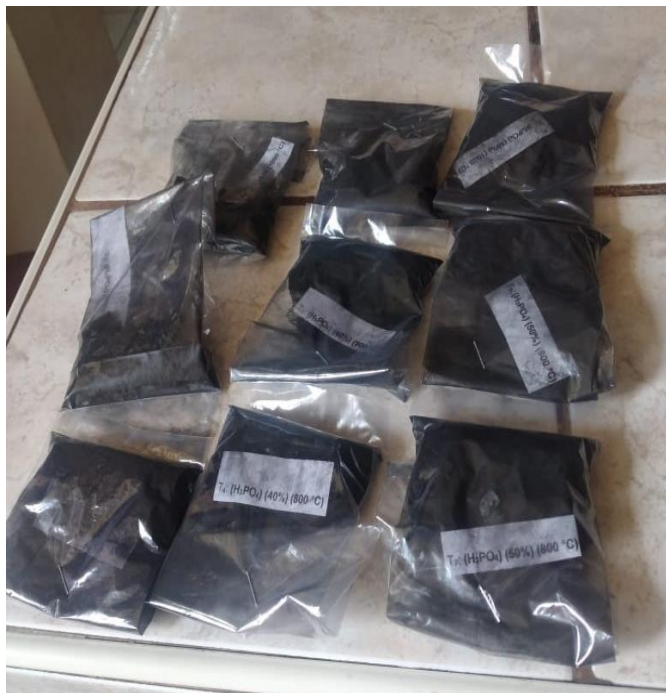
Figura 8. Carbón activado con Ácido fosfórico ( H_3PO_4 ) a partir del aserrín de Simarouba amara Aubl. (marupa)
