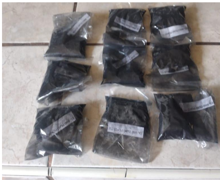
Figura 9. Carbón activado con Cloruro de Zinc ( \text{ZnCl}_2 ) a partir del aserrín de Simarouba amara Aubl. (marupa).
