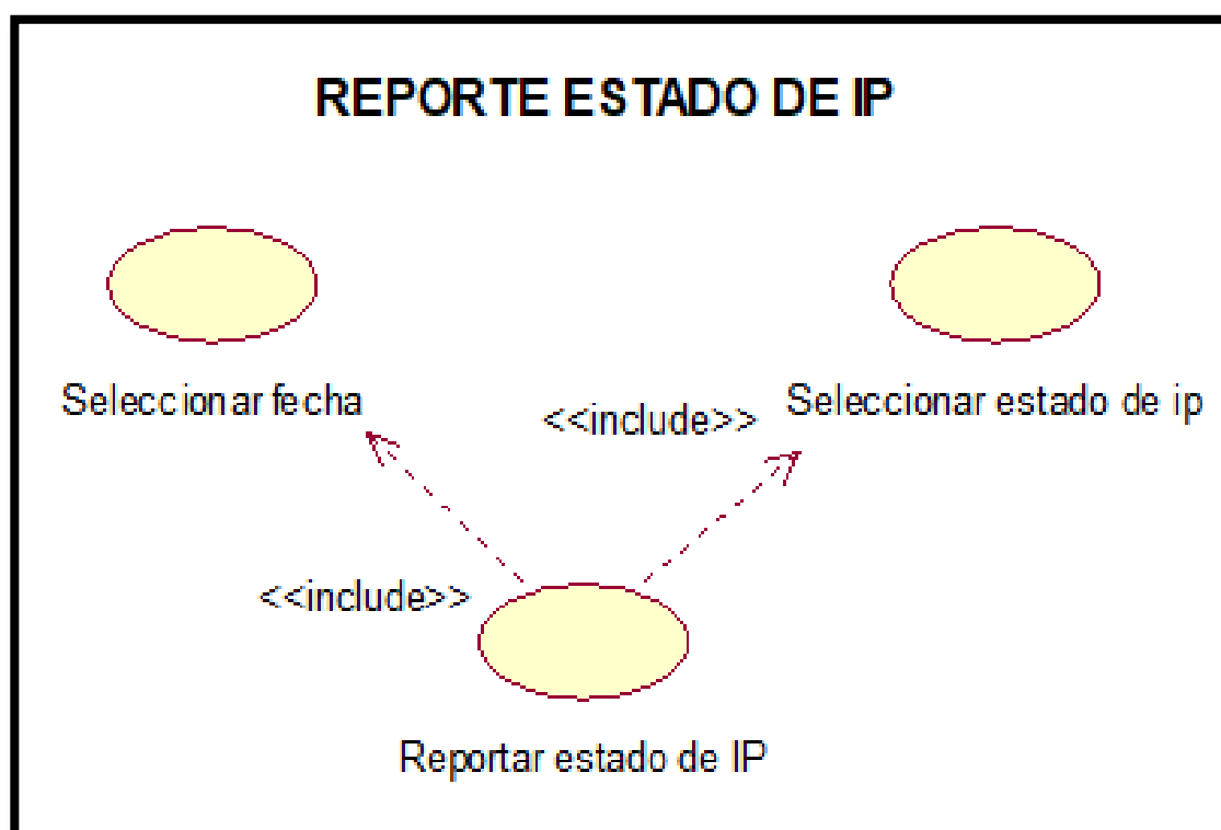
Figura 20: C-U Requerimiento: Reporte Estado IP
