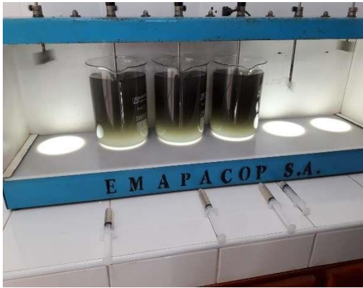
Figura 26. Muestra de agua residual antes de verter el coagulante de Moringa
