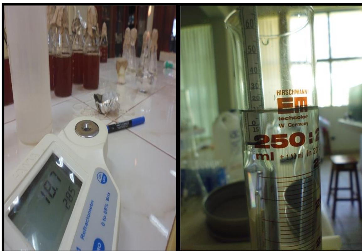
Figura 23A. Refractómetro digital y lectura de °GL en el alcoholímetro.
