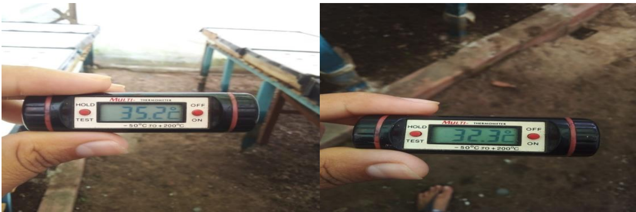
Figura 22A. Temperatura dentro del invernadero, antes y después de hacer uso del equipo de aire acondicionado.
