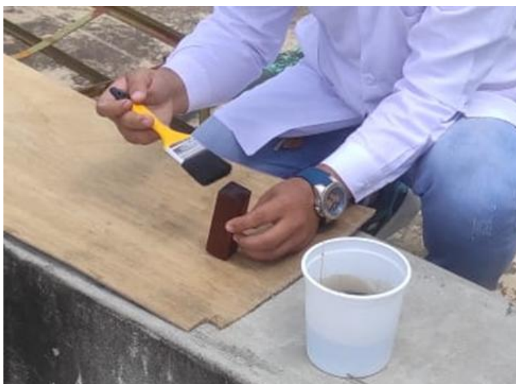
Figura 11. Método del brochado
