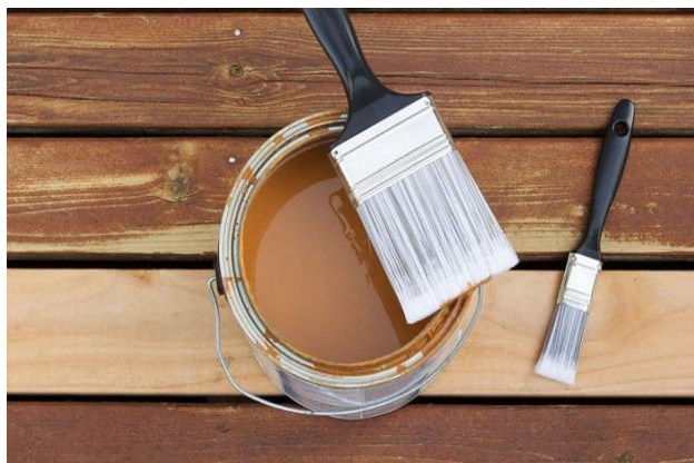
Figura 7. Protección de la madera por brochado
