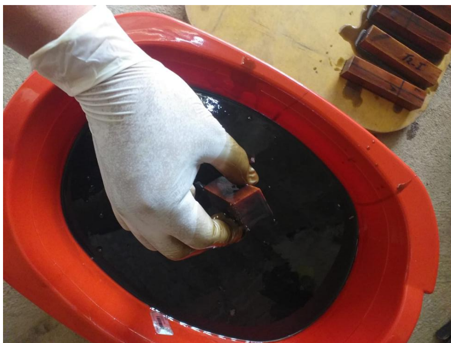
Figura 18. Inmersión de la madera con aceite residual de moto
