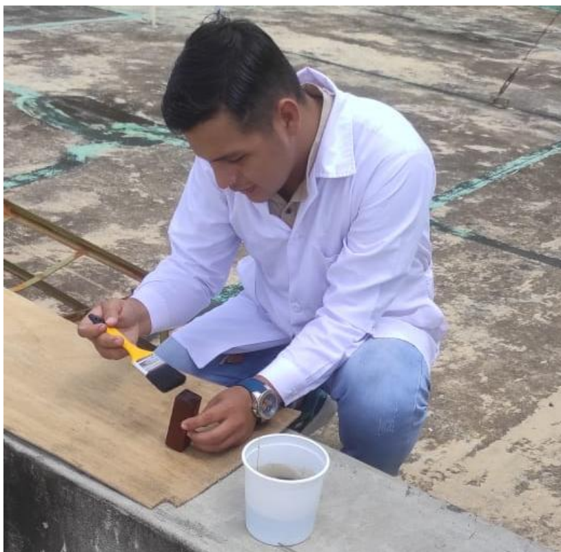
Figura 17. Brochado de la madera con aceite residual
