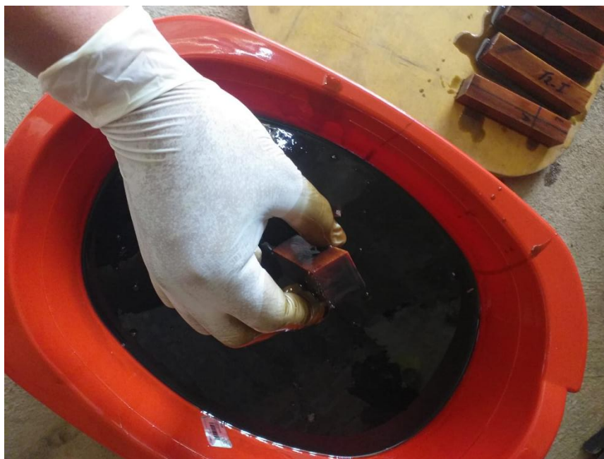
Figura 12. Método de inmersión
